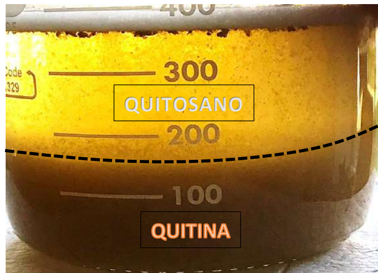
Figura 2. Muestra de productos del proceso de desacetilación con NaOH.
