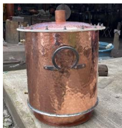
Figura 11. Montera con nuevos aditamentos y adaptación para los sensores de temperatura.
