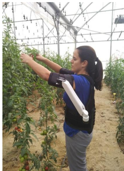
Figura 2. Exoesqueleto pasivo desarrollado por Tecnova (Tecnova, 2024)
