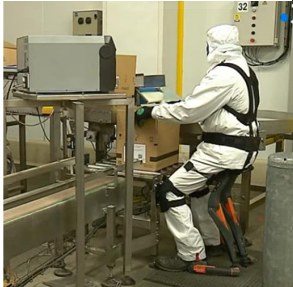
Figura 1. Ejemplo de exoesqueleto ergonómico para descanso en actividades de labor industrial (GOBIO, 2024)
