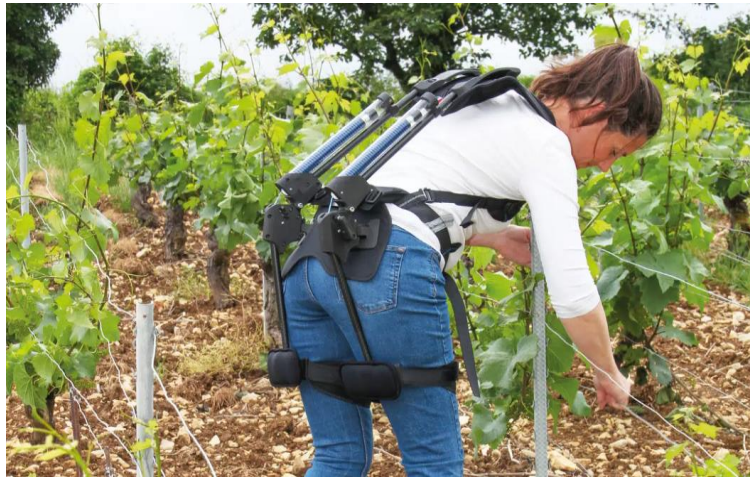
Figura 3. Exoesqueleto pasivo desarrollado por ORTHEXO (ORTHEXO, 2024)
