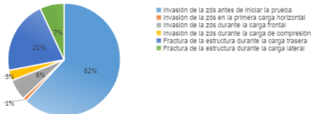
Figura 4. Porcentaje de las causas por las que las estructuras probadas no cumplieron con los criterios de aceptación establecidos por la norma NMX-O-181-SCFI-2016.
