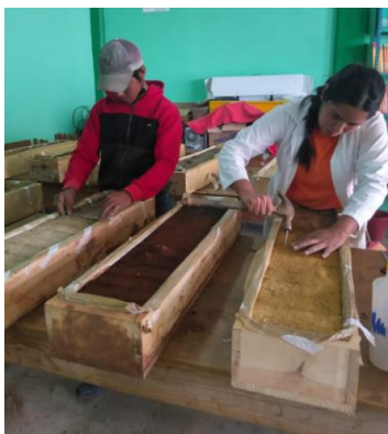
Figura 7. Procesamiento para impregnación y endurecimiento de los suelos.
