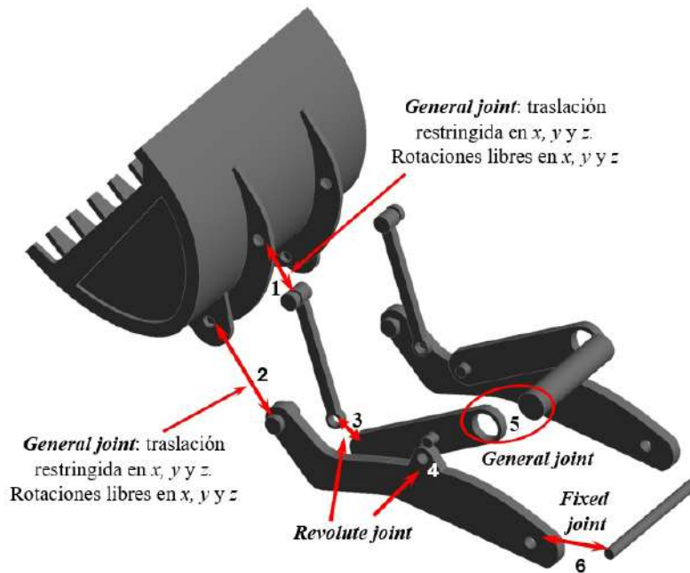
Figura 1. Conexiones entre los elementos del mecanismo de cargador frontal
