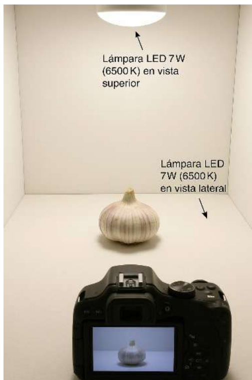
Figura 1 Configuración experimental para la adquisición de imágenes en condiciones controladas.
