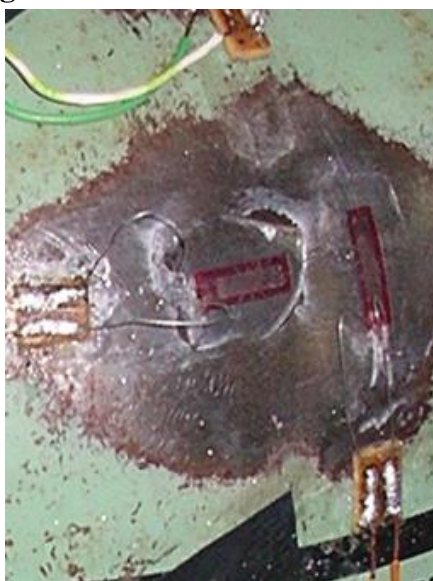
Figura 4 b. Detalle del pegado de los extensómetros eléctricos
